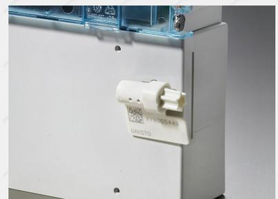
Sicherheitsplombe für den Versorgungssektor, die an verschiedenen Arten von Energiezählern zur Anwendung kommen kann. Das einzigartige Drehknopfdesign mit Sollbruchstelle hinterlässt Spuren bei Manipulationen vor und nach dem Verschliessen. Barcodiert oder nummeriert für eine schnelle, genaue und zuverlässige Datenerfassung und rationalisierte Arbeitsabläufe. Auswahl aus verschiedenen Farben zur Identifikation bei Anwendung und für höhere Effizienz.
