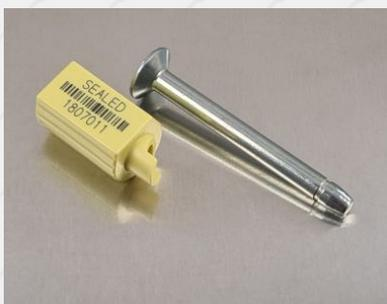
ISO 17712 Hochsicherheitsplombe (Bolzenplombe aus Stahl und mit Kunststoffüberzug) für alle Arten von Containern. Mit einer Zugbelastbarkeit von mindestens 2000 kg, verhindert Unisto Hi-Genius Gelegenheitsdiebstähle. Einfache Anbringung von Hand. Für das Entfernen ist ein Bolzenschneider erforderlich. Die Nummerierung auf dem Bolzen und Gehäuse verhindert ein Austauschen der Teile. Erhältlich in verschiedenen Farben. Kundenname oder Logo zur eindeutigen Identifikation.
